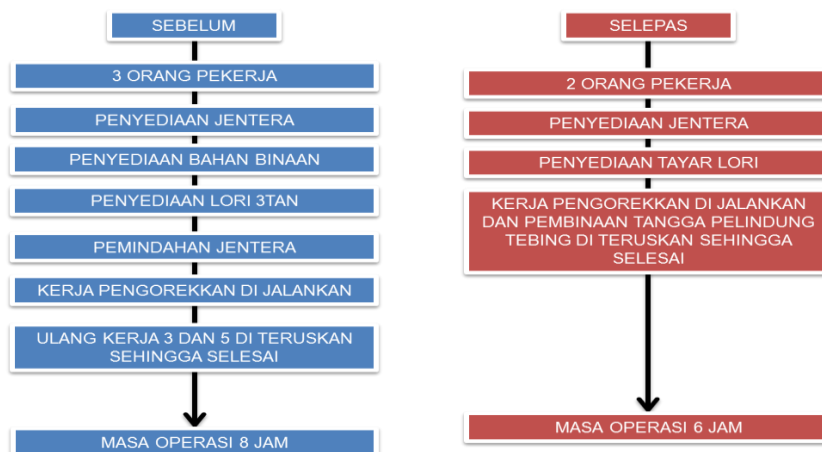
Jadual 9: Carta alir kerja-kerja penyelenggaraan ban menggunakan tangga plindung tebing menunjukkan hasil pengurangan proses kerja dan dapat meningkatkan mutu produktiviti kerja dan kepuasan hati pelanggan.
