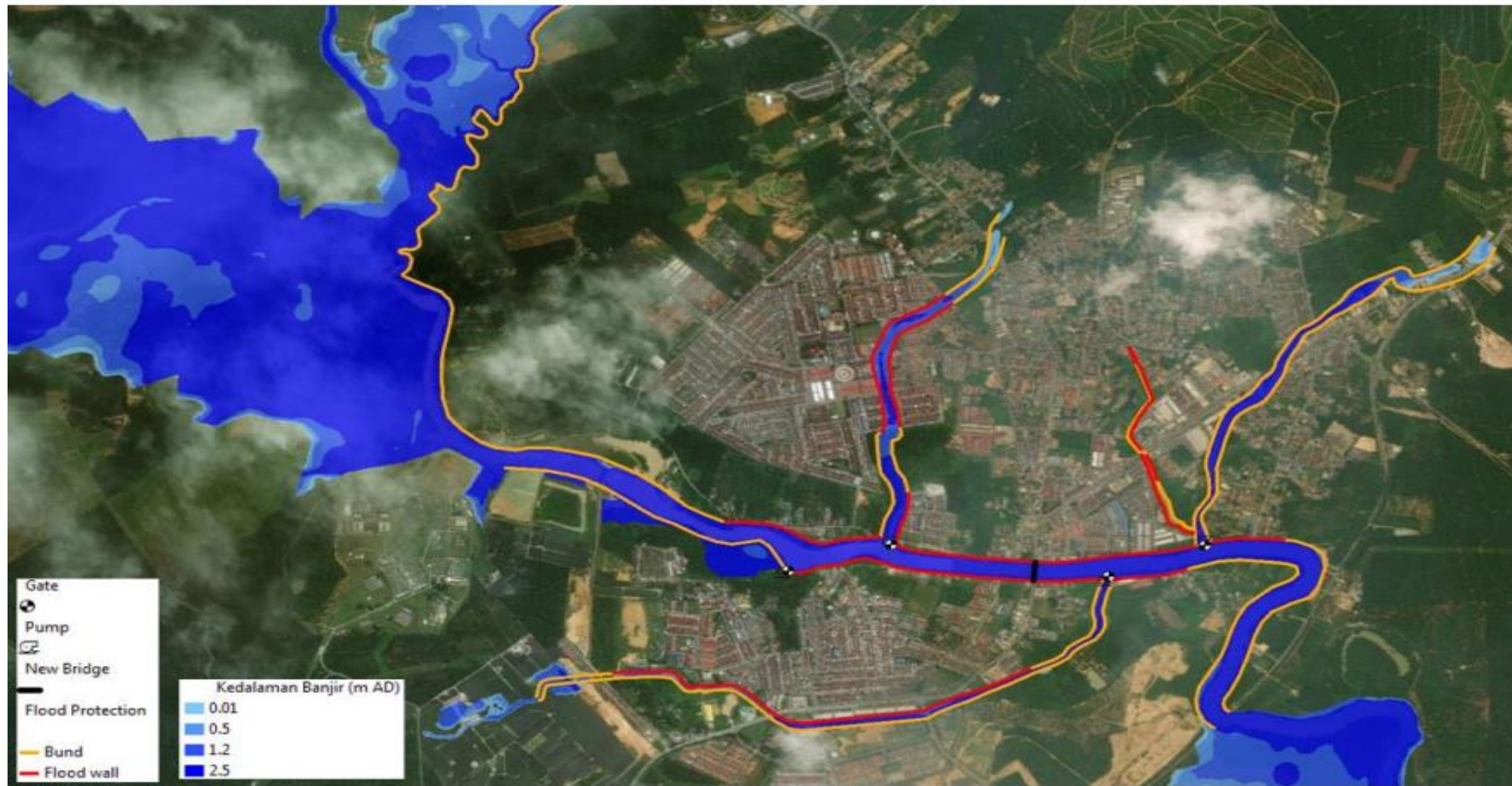
Gambarajah 14: Peta Hazard Banjir di Bandar Kota Tinggi – Dengan Projek Tebatan Banjir
